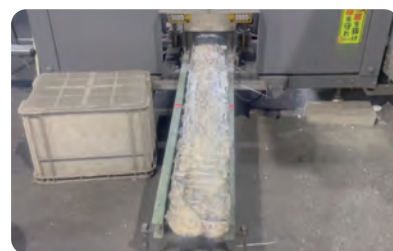
溶融固化処理
